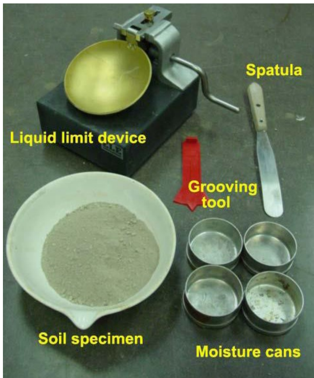
Fig. 3 Casagrande cup test (Holtz & Kovacs, 1981)
